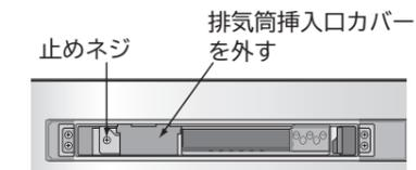
③設置後、ビルトイン電気オーブンレンジに付属している排気筒を表示に合わせて挿入してねじ止めする
