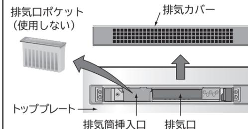
②設置前にHクッキングヒーターの排気口内に取り付けてある止めネジと排気筒挿入口カバーを工具などを使って外す
