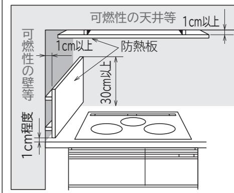
防熱板はこれを設けたとき、機器周囲の可燃物の温度が室温35°Cの時100°Cを越えない断熱性を有すること。
