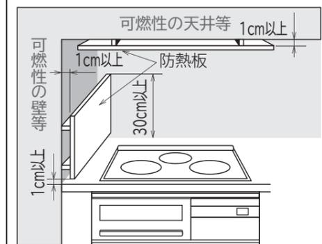
防熱板はこれを設けたとき、機器周囲の可燃物の温度が室温35℃の時100℃を越えない断熱性を有すること。本体の後面に取り付ける場合も、側面と同じ距離を設けてください。
