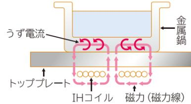
IHとは電磁誘導加熱 (Induction Heating) のこと。IHコイルから発生した磁力(磁力線)が、金属製の鍋を通るとき、うず電流が発生し鍋自体を加熱させます。
