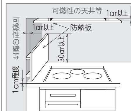
防熱板はこれを設けたとき、機器周囲の可燃物の温度が室温35°Cの時100°Cを越えない断熱性を有すること。
