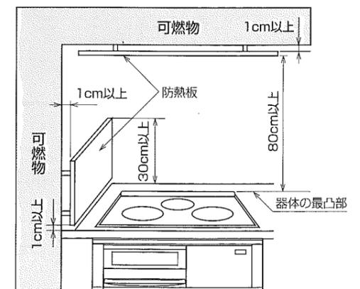
防熱板はこれを設けたとき、機器周囲の木壁温度が室温35℃の時100℃を越えない断熱性を有すること。
