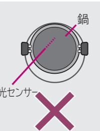
光センサーの上に置かれても左・右IHヒーターの中央から大きくずれている
