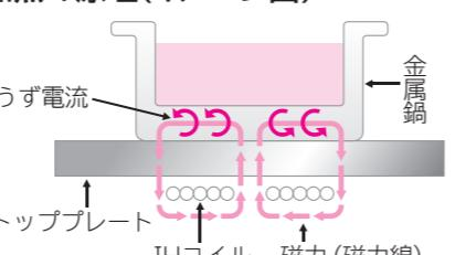
IHとは電磁誘導加熱(Induction Heating)のこと。IHコイルから発生した磁力(磁力線)が、金属製の鍋を通ると、うず電流が発生し鍋自身を発熱させます。
