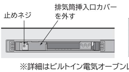
③設置後、ビルトイン電気オーブンレンジに付属している排気筒を表示に合わせて挿入してねじ止めする
