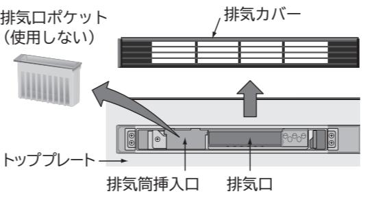
②設置前にIHクッキングヒーターの排気口内に取り付けてある止めねじと排気筒挿入口カバーを工具などを使って内側から外す
