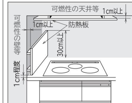
防熱板はこれを設けたとき、機器周囲の可燃物の温度が室温35℃の時100℃を越えない断熱性を有すること。
