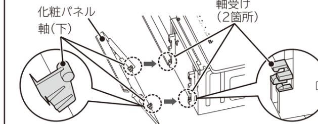
②化粧パネルを本体側に倒し込み、軸(上)とツメを奥まで確実に押し込み固定する
