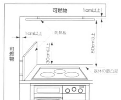
防熱板はこれを設けたとき、機器周囲の木質温度が室温35℃の時100℃を越えない断熱性を有すること。
