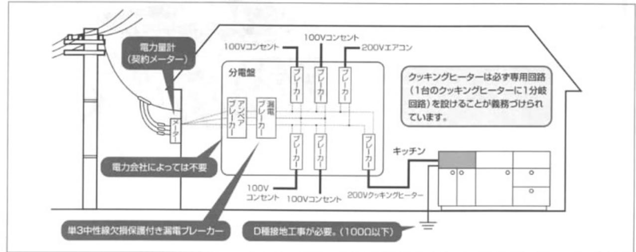
●クッキングヒーター用のコンセントは規格で次のようなものが標準品となっていますので、事前にご確認の上、設置してください。
