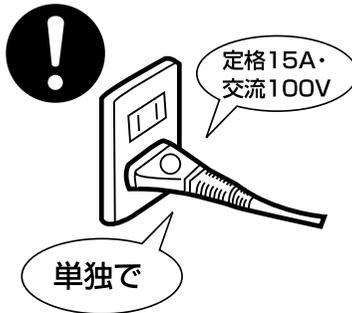
他の機器と併用すると発熱による火災の原因になります。
