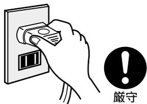
電源コードは、途中で接続したり延長コードの使用や他の電気器具とのタコ足配線をしないでください。感電や発熱・火災の原因になります。
