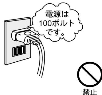
電源コードを極端に折り曲げないでください。感電や漏電火災の原因になることがあります。
