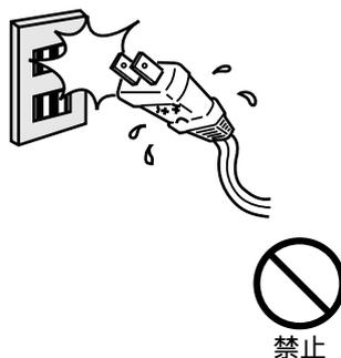
定格電圧（单相100V）以外で使わないでください。定格電圧以外で使用すると、感電や火災の原因になります。
