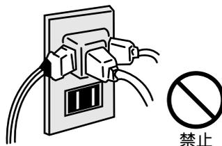
電源コードは、破損させたり加工したりしないでください。感電や火災の原因になります。電源コードは、重いものを載せたり、加熱したり、引っ張ったりすると破損の原因になります。
