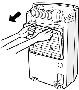
**2** エアフィルターから空気清浄フィルターを取り外してください。エアフィルターの汚れは水で洗い流すか、掃除機で吸い取ります。水洗いの場合は日陰で十分乾かしてください。
