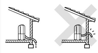
サポートタンクを取り付けずに運転しますと、水受容器を取り外したとき、除湿機内に溜まった除湿水が滴下します。
