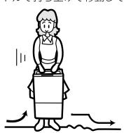
●除湿機を移動するときは、運転を止めてオートルーバーを閉じ水受容器内の水を捨て、水受容器を入れてから移動してください。水が入ったまま移動しますと、水が波立ち水受容器からあふれ出し、床面を濡らす原因になります。
