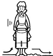
●除湿機を移動するときは、運転を止めて水受容器内の水を捨て、水受容器をいれてから移動してください。水が入ったまま移動しますと、水が波立ち水受容器からあふれ出し、床面を濡らします。
