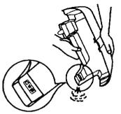
**4** 本体を押さながら水受容器を両手で押して、後ろに当たるまで確実に押し込みます。
