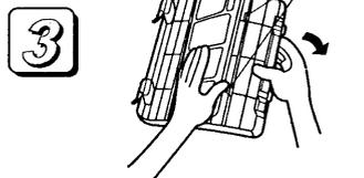
**4** 空気清浄フィルターをつけたエアフィルターの下側にあるつめを、本体に掛けます。ツマミを下に押しながら本体に取り付けます。
