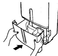
**2** 水受容器の取っ手の部分と下側を持ち、静かに運び、水受け容器を傾け「排水口」と刻印された部分から水を捨てます。
