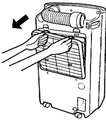
2 エアフィルターから空気清浄フィルターを取り外してください。エアフィルターの汚れは水で洗い流すか、掃除機で吸い取ります。水洗いの場合は日陰で十分乾かしてください。
