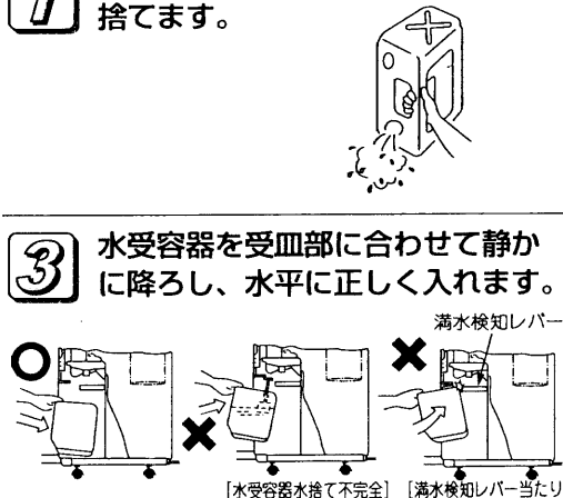
〔水受容器水捨て不完全〕 〔満水検知レバー当たり〕
