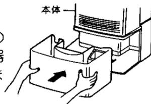
2 中央部を押して容器が後に当たるまで確実に押し込みます。
