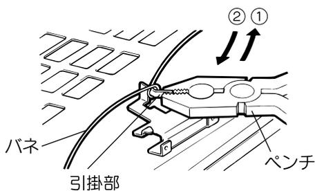
(1)バネを固定しているグリルの引掛部をペンチなどで開き、バネを外します。
