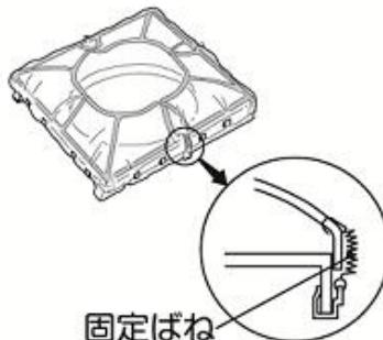
7. のびのびフィルターを取り付けた換気扇
