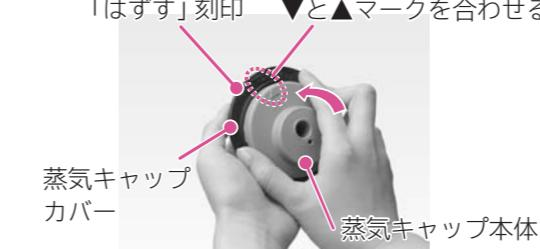
上図のように持ち、蒸気キャップ本体の▲マークを「はずす」の方向に回し、カバーの▽マークと位置を合わせて外す。
