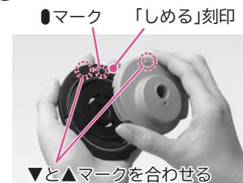
蒸気キャップ本体の▲マークをカバーの▽マークの位置と合わせ、3ヶ所の爪を確実にはめ込み「しめる」の方向に回してカバー●のマークの位置まで回して取り付ける。
