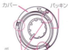
②キャップ本体の▲マークをカバーの▼マークの位置と合わせ、3ヶ所の爪を確実にめ込み「しめる」の方向に回してカバーの■マークの位置まで回して取り付ける。
