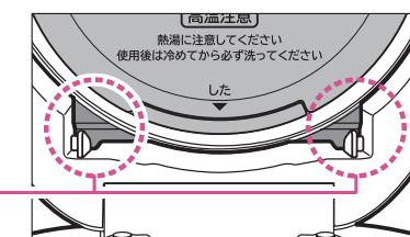
両側のツメがふたの溝に差し込まれていないと、ふたを閉めるときにツメが破損したり、変形することがあります。
