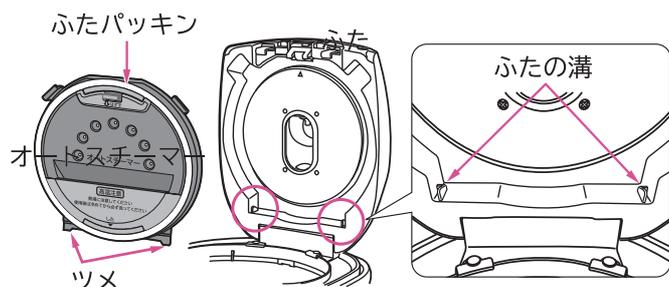
両側のツメがふたの溝に差し込まれていないと、ふたを閉めるときにツメが破損したり、変形することがあります。
