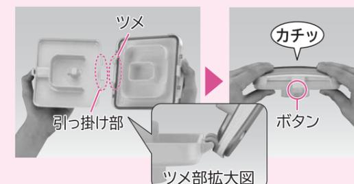
蒸気キャップカバーのツメを蒸気キャップ本体の引っ掛け部に差し込んでから(2ヶ所)閉めてください。片側のみ(1ヶ所)を差し込んだ状態だと、蒸気キャップを閉めるときに、ツメが破損することがあります。
