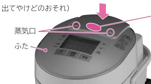
蒸気キャップをふたの凹み部に合わせ、蒸気キャップ上面前方中央部を止まるまで押し下げて取り付ける
