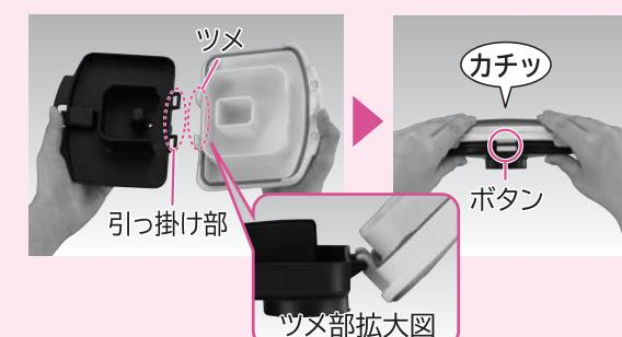
蒸気キャップカバーのツメを蒸気キャップ本体の引っ掛け部に差し込んでから（2ヶ所）閉めてください。片側のみ（1ヶ所）を差し込んだ状態だと、蒸気キャップを閉めると、ツメが破損することがあります。
