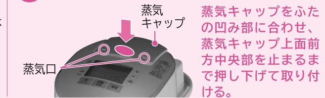
蒸気キャップをふたの凹み部に合わせ、蒸気キャップ上面前方中央部を止まるまで押し下げて取り付ける。
