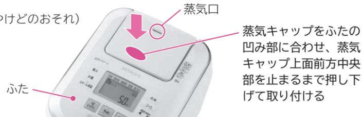
蒸気キャップをふたの凹み部に合わせ、蒸気キャップ上面前方中央部を止まるまで押し下げて取り付ける
