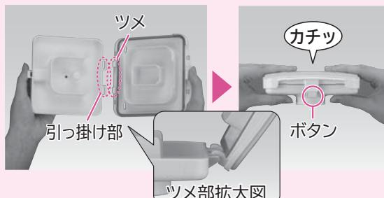
蒸気キップカバーのツメを蒸気キップ本体の引っ掛け部に差し込んでから(2ヶ所)閉めてください。片側のみ(1ヶ所)を差し込んだ状態だと、蒸気キップを閉めるときに、ツメが破損することがあります。
