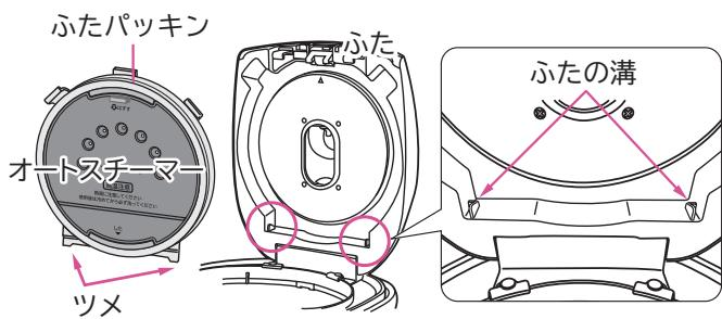
両側のツメがふたの溝に差し込まれていないと、ふたを閉めるときにツメが破損したり、変形することがあります。
