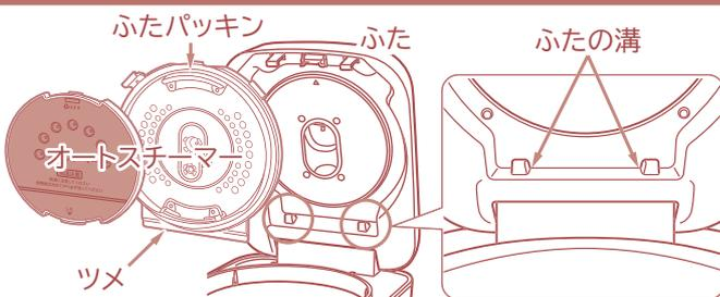
両側のツメがふたの溝に差し込まれていないと、ふたを閉めるときにツメが破損したり、変形することがあります。
