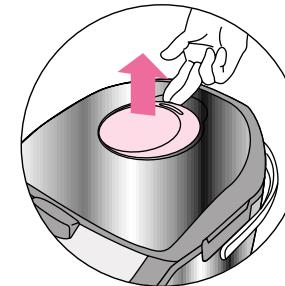
②図のようにもち、キャップ本体のマークを「はずす」の方向に回し、カバーのマークと位置を合わせるとはずれる。
