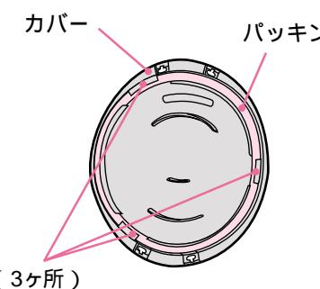
②キャップ本体のマークをカバーのマークと位置を合わせ、3ヶ所の爪を確実にめ込み「しめる」の方向に回してカバーの●マークの位置まで回して取りつける。
