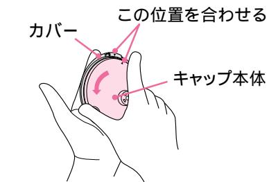
③調圧キャップの中央部を押さえて、確実に差し込む。
