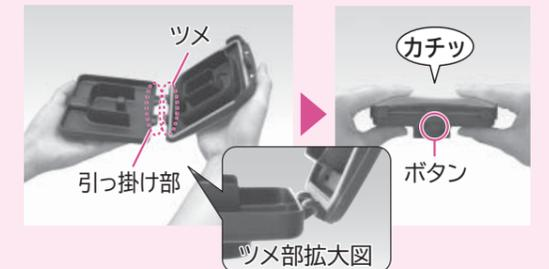
蒸気キャップカバーのツメを蒸気キャップ本体の引っ掛け部に差し込んでから(2ヶ所)閉めてください。片側のみ(1ヶ所)を差し込んだ状態だと、蒸気キャップを閉めるときに、ツメが破損することがあります。
