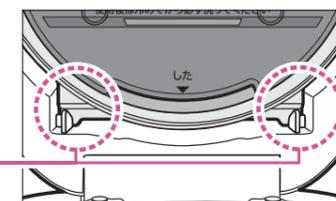
両側のツメがふたの溝に差し込まれていないと、ふたを閉めるときにツメが破損したり、変形することがあります。
