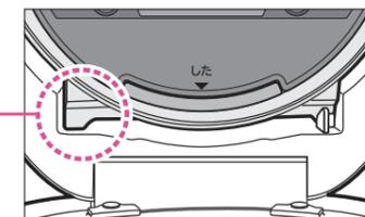
ふた加熱板はステンレス製ですが、水分に含まれる鉄分や塩素成分により、錆(サビ)が発生する場合があります。ふた加熱板は、使用後きれいに洗い、水分をよくふき取り、ふた加熱板とプレートに分けて自然乾燥してください。
