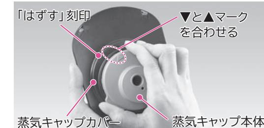
上図のように持ち、蒸気キャップ本体の▲マークを「はずす」の方向に回し、カバーの▼マークと位置を合わせて外す。
