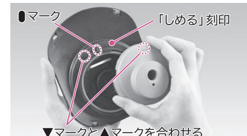
蒸気キャップ本体の▲マークをカバーの▼マークの位置と合わせ、3ヶ所の爪を確実にはめ込み「しめる」の方向に回してカバー●のマークの位置まで回して取り付ける。
