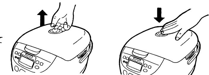
調圧蒸気キャップ内部の汚れがひどくなったときは、下記の方法で分解し、内部を洗ってください。
