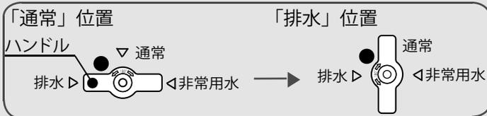
貯湯ユニットの水を排水します。排水口から水があふれないようタンク排水栓の開き具合を調節してください。
