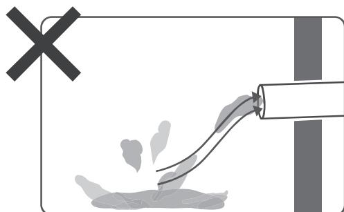
排水トラップがないので、浄化槽などからの下水ガスが逆流します。
