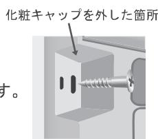
木ネジの締め付けすぎに注意してください。締めすぎるとリモコンの破損や、ボタン操作の不具合の原因になります。
