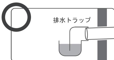
排水トラップが給湯機の膨張水により封水され、下水ガスが逆流しません。
