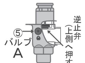
逆止弁位置(給水継手左視図)
