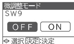
浴そうの設置が後日で、設置までの期間給湯専用機として使用する場合にふろ機能が動作しないようにすることができます。
