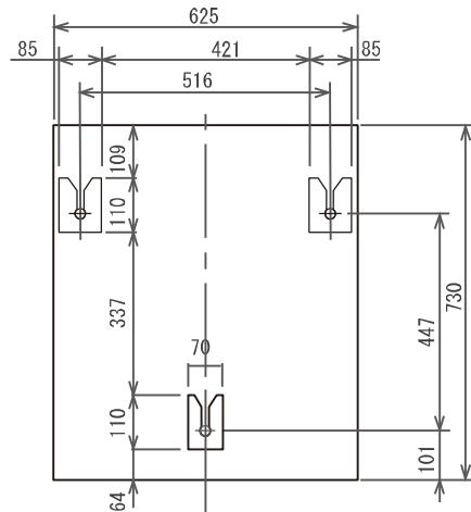
ヒートポンプユニット (BHP-HAW453、BHP-HAW603)
