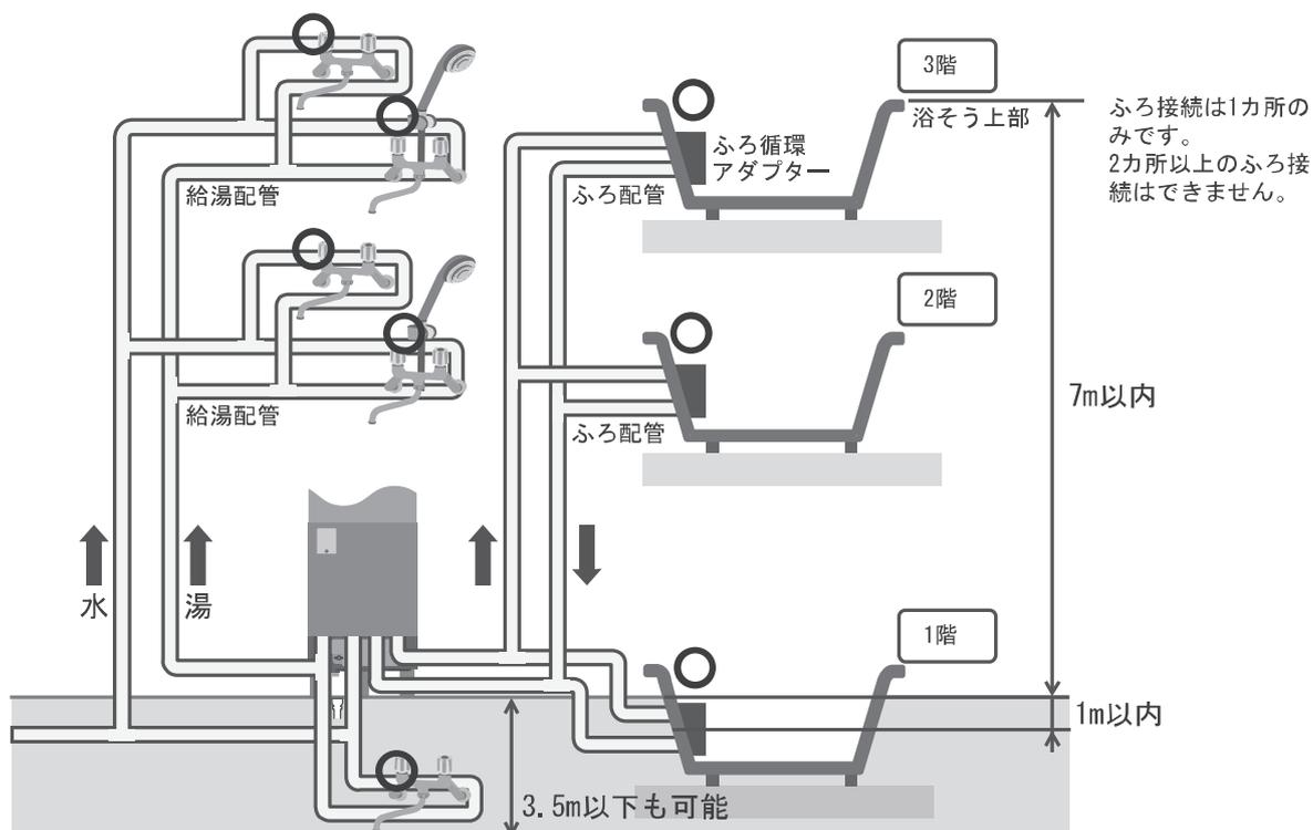
● 階上給湯、階下給湯とも給水圧は0.2MPa以上必要です。
