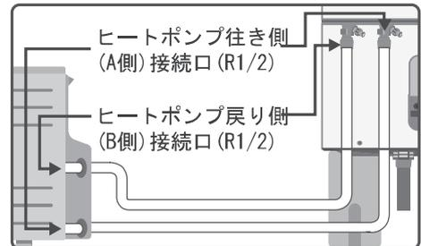
1 貯湯ユニット側の接続口は、水抜き栓を取りはずしません。(作業性向上)(2カ所)
