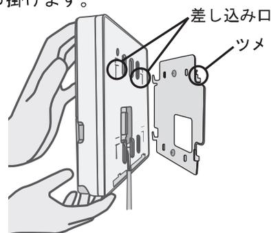
少し強くカチッと音がするまで、リモコンを下方にスライドさせ、リモコン取付板に固定してください。
