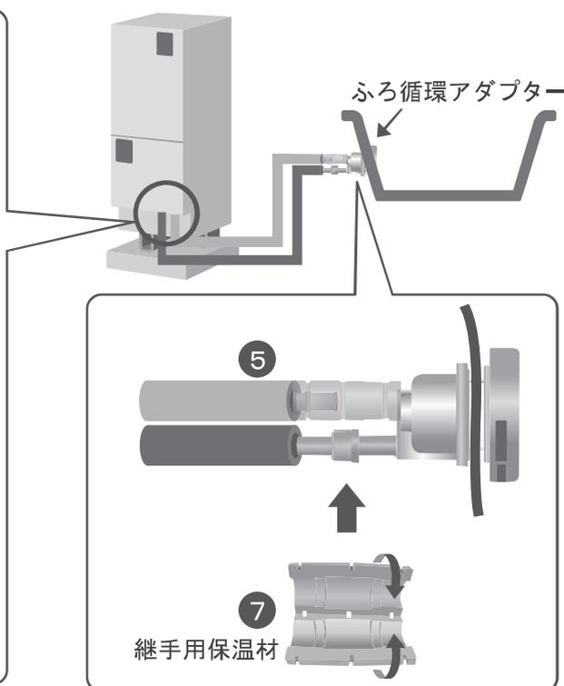
**1** 貯湯ユニット側の接続口は、水抜き栓を取りはずしません。(作業性向上)(2カ所)
