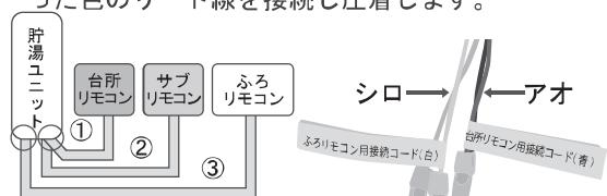
**ご注意** 上記と異なる接続をした場合、貯湯ユニットの本体基板が破損します。
