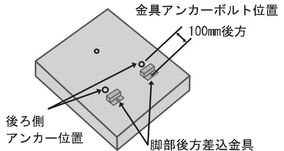
**2 脚部後方差し込み金具を固定する**
