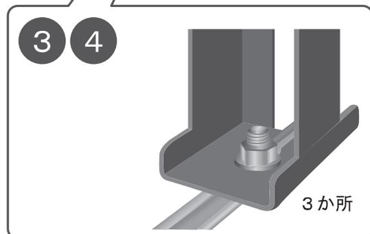
貯湯ユニットを2階以上に据付ける場合や、脚部後方差込金具で固定した場合などは、必ず横揺れ防止対策を行ってください。
