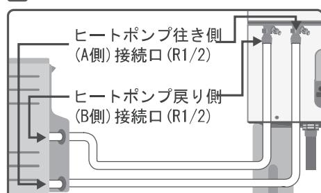
1 貯湯ユニット側の接続口は、水抜き栓を取りはずします。(作業性向上)(2カ所)
