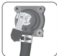
□ 排水栓を閉めていても、沸き上げ中はタンク排水管より少量の膨張水を排出することを説明してください。
