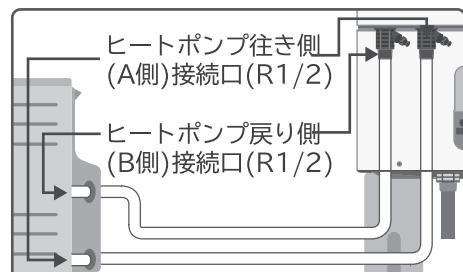
1 貯湯ユニット側の接続口は、水抜き栓を取りはずします。(作業性向上)(2力所)
