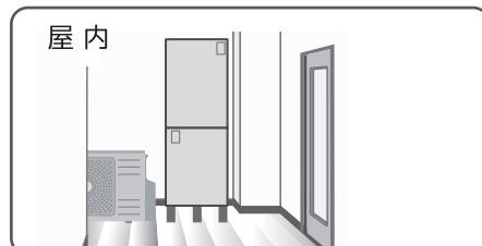
屋内 万一、冷媒がもれると酸素不足の原因となります。
