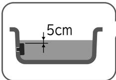
□ 本製品は、ふろ配管凍結防止のため外気温が下がると自動的に浴そうのお湯を循環させて凍結防止運転を行います。凍結が予想される時期は、浴そうのお湯を抜かないでふろ循環アダプター上端より5cm以上残しておくようお願いしてください。
