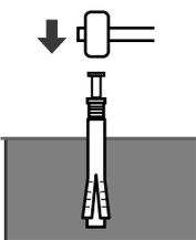
アンカーボルトをいれ、ハンマーで打ち込む。
