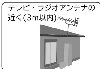
テレビ・ラジオアンテナの近く(3m以内)に据え付けると、テレビ・ラジオに映像のみだれや雑音が生ずることがあります。
