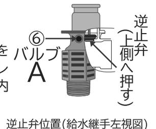
逆止弁位置(給水継手左視図)
