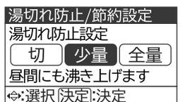
● タンクの湯切れ時（昼間）に沸き上げるお湯の量を設定します。お客様の希望がない場合は「少量」に設定します。
