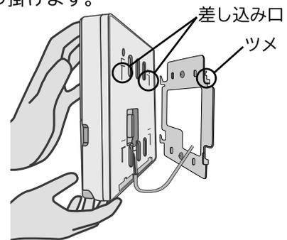
少し強くカチッと音がするまで、リモコンを下方にスライドさせ、リモコン取付板に固定してください。
