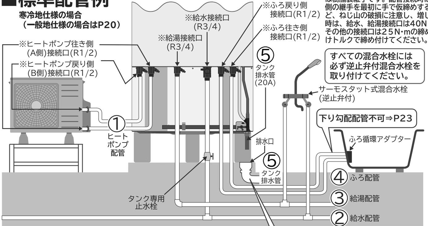
※ 給水・給湯接続口、ふろ行き・戻り接続口、ヒートポンプ行き・戻り接続口は樹脂製継手です。配管接続時は配管側の継手を最初に手で仮締めするなど、ねじ山の破損に注意し、増し締め時は、給水、給湯接続口は40N・m、その他の接続口は25N・mの締め付けトルクで締め付けてください。
