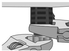
**4** ナット付アダプタに付属しているパッキンを取り付け、止水栓に接続します。(※1)
