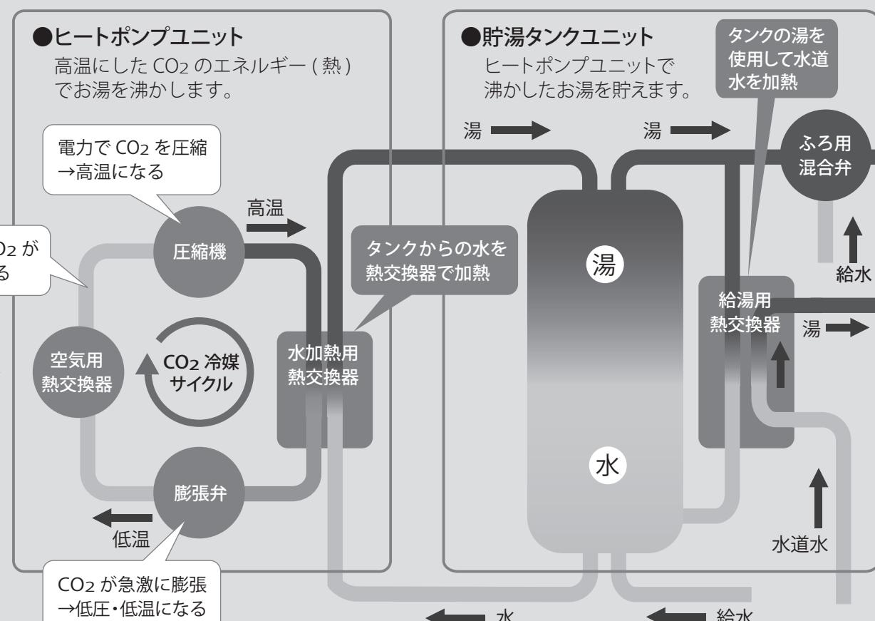
水加熱用熱交換器で水を加熱したCO<sub>2</sub>は、膨張弁で急激に膨張することにより低温・低圧になり、空気用熱交換器で大気から熱を吸収して再び圧縮機へ送られます。
