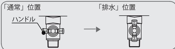
貯湯タンクユニットの水を排水します。排水口から水があふれないようタンク排水栓の開き具合を調節してください。
