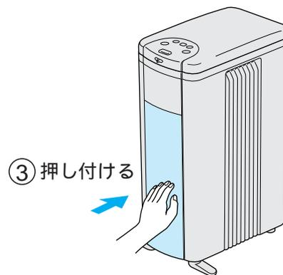
化粧パネルの「上」と表示してあるほうを上方向にして、パネルの下側に差し込み、全体を押し付けます。爪が「パチッ」と音がするまで押し付け、すき間がなくなるようにしてください。
