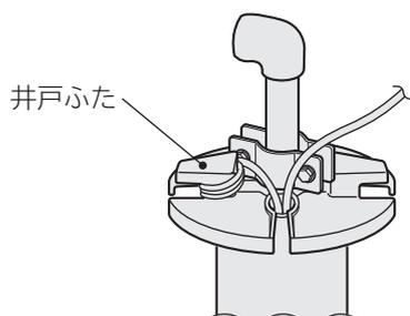
ロープは据え付け後2~3日しますと伸びてゆるむことがありますので締め直してください。
