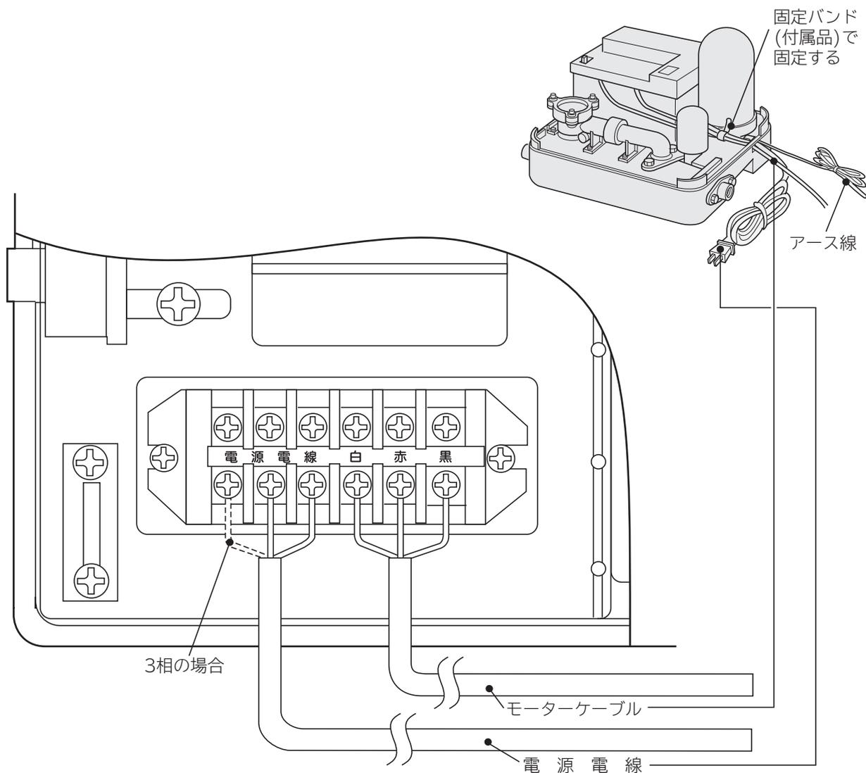
**ご注意** ●3相用ポンプ(SFM-K750W)でモーター軸が逆回転した場合は、3本の電源電線のうち2本を入れ替えてください。
