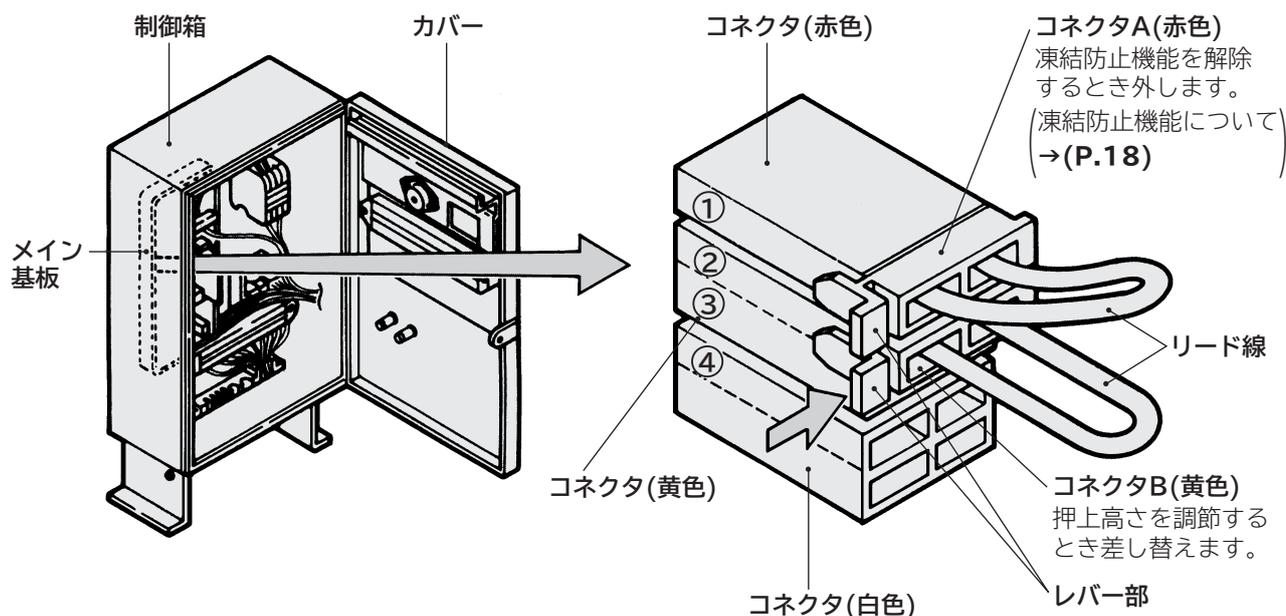
**ご注意** ●押上高さ調整コネクタ、凍結防止機能解除コネクタ以外は、触れないでください。感電や故障の原因になります。
