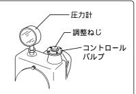
井戸水位の低下などで揚水量が 減少した場合は、コントロール バルブ調整圧力を高めに設定し てください。
