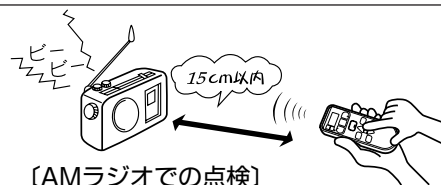
〔AMラジオでの点検〕
