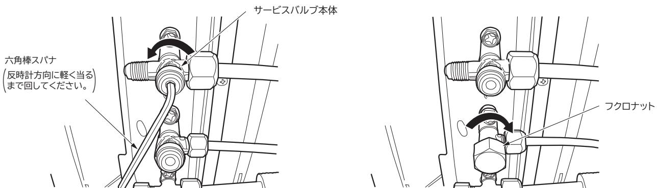
右図の部分をガス漏れ検知器を使用してフレアナット接続部などから冷媒漏れがないことを確認します。
