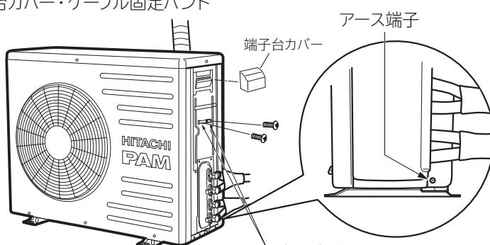
②端子台にFケーブル・電源ケーブルを接続し、必ずケーブル固定バンドで固定してください。
