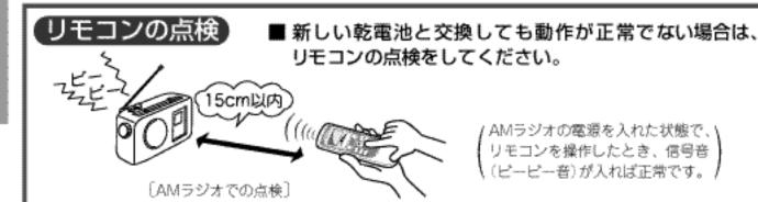
AMラジオの電源を入れた状態で、 リモコンを操作したとき、信号音 (ビービー音)が入れば正常です。
