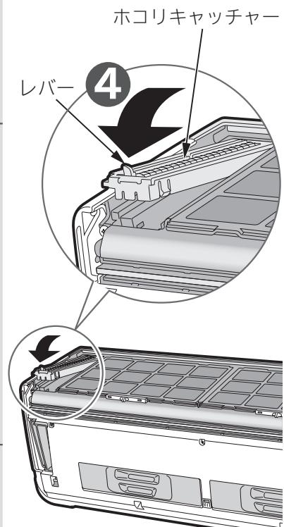
**ご注意** ホコリキャッチャーが正しく取り付けられていないと、フィルター掃除運転が正常に行われず、故障の原因となり、クリーンランプが点滅します
