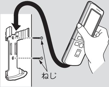
●リモコンの上部を持って上方方向に引き抜く。
