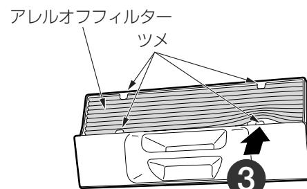
**3** アレルオfffィルターを取付枠に合わせて取り付ける
