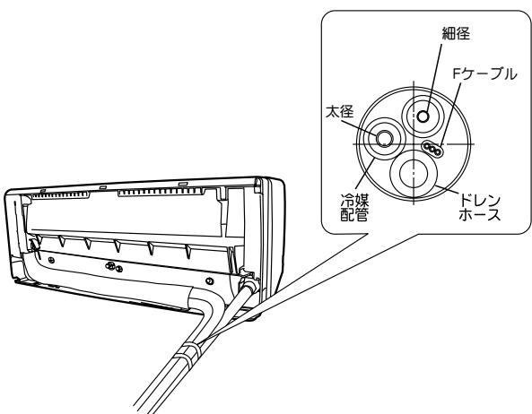
④Fケーブル・配管を整形し、室内機背面の下部スペースに納め、結束バンド(市販品)を背面フックに引っ掛け固定します。
