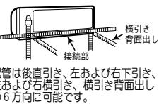
横引きなど室内を通す配管は、保冷用断熱材をかぶせてください。
