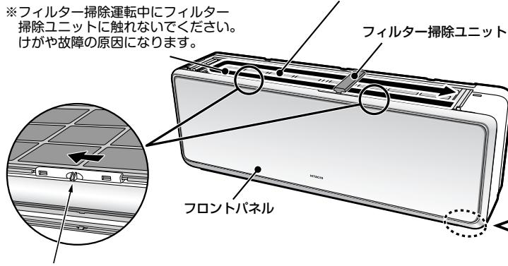
※エアフィルター（ステンレスフィルター）が確実に取付けられて、エアフィルターロックがロック側（左端）に固定されていることを確認してください。
