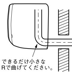
冷媒配管の曲げ始めが壁穴範囲から出ていたり、曲げRが大きいと、室内機が壁から浮き上がり、仕上りが悪くなる原因となります。
