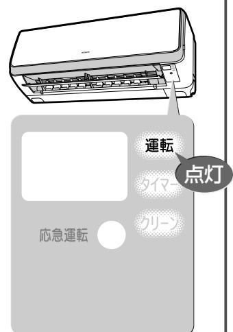
冷房・設定温度27°C・風速“自動”的ときの表示例
