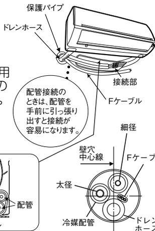
配管接続のときは、配管を手前に引っ張り出すと接続が容易になります。
