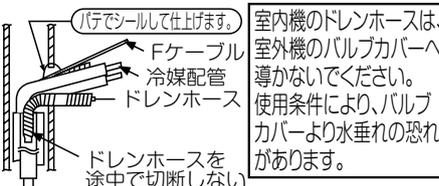
室内機のドレンホースは、室外機のバルブカバーへ導かないでください。使用条件により、バルブカバーより水垂れの恐れがあります。
